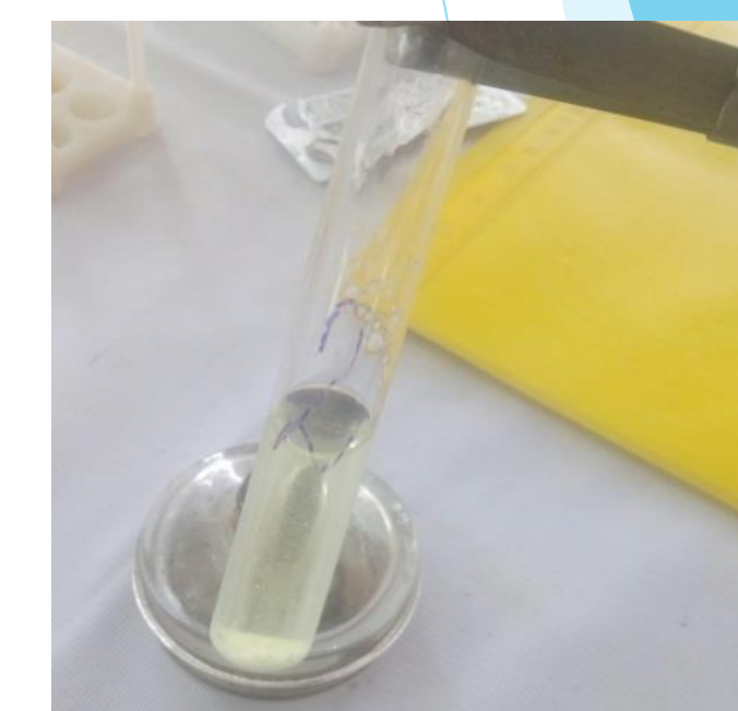
Рис. 6. Кипячение парацетамола в соляной кислоте
